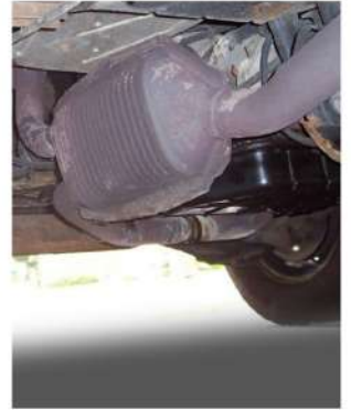
圖25、在汽車中使用的觸媒轉換器，可以減少汽車排放有害的氮氧化物。
