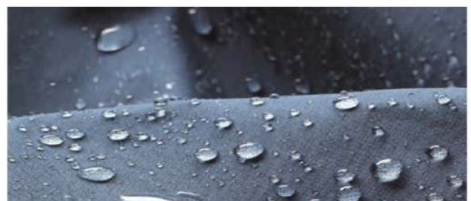
圖8、把「鐵氟龍」加熱及拉長形成薄膜。這會在薄膜上創造出看不見的細孔——每平方吋有幾十億個之多——小得連小水滴都進不去，但會大得足以讓汗水的水分子逸出。(圖片來源：Goretex官網)
