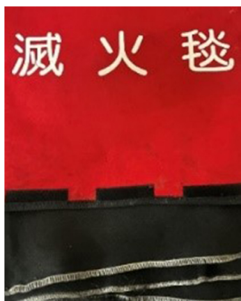
圖21、二氧化矽含量達95%以上的高矽纖維製造而成的滅火毯
