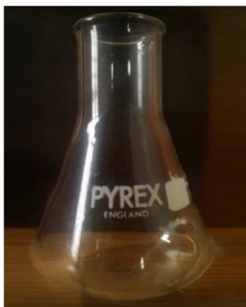
圖42、派熱克斯玻璃(Pyrex)是在二氧化矽、碳酸鈉、碳酸鈣的混合物中加入氧化硼熔製而成 © CC BY-SA 3.0
