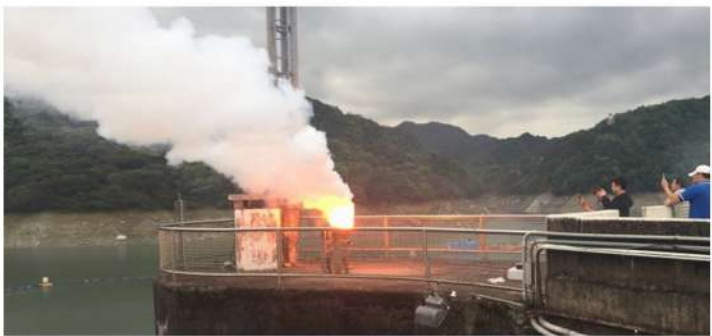
圖24、人造雨，藉由地面燃燒「氯化鉀」，讓上空的雲層的雲滴增大，形成降雨。 圖片來源：2015/04/21，自由時報，石門水庫管理中心提供
