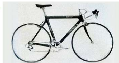
圖13、鈦鋁合金已使用在自行車車架上
