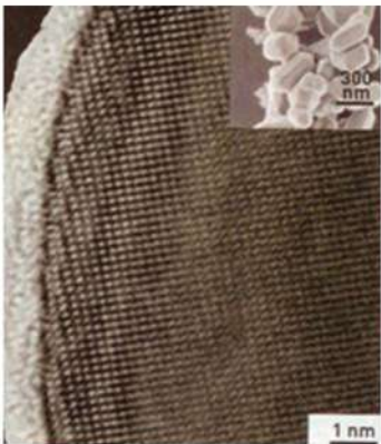
圖17、這是一個二氧化鈦顏料分子的晶體晶格，它的外表是一層奈米狀的砂包裹著。 右上角插圖：展示著該二氧化鈦顏料的粒子型態。
