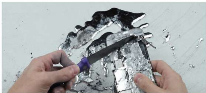
(f) 用小刀就輕易將背蓋整個拆下。
