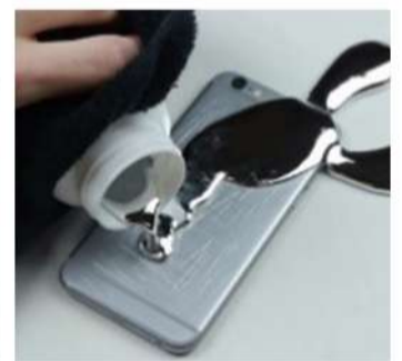
(a) 先將iPhone背蓋刮花了以後，(b) 在手機背蓋上倒500克的液態「鎵」。
