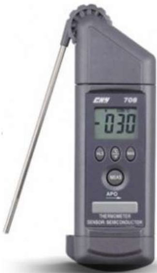
圖12、電阻溫度計：分為金屬（主要有用鉑、金、銅、鎳等）和半導體（主要用碳、鍺等），都是根據電阻值隨溫度的變化特性製成，測量範圍在-260℃~600℃。此圖為半導體溫度計。
