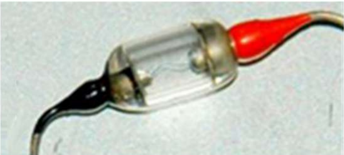
圖16、「鍺」可用於生產晶體管。此圖的「鍺二極管」製於1950年代。
